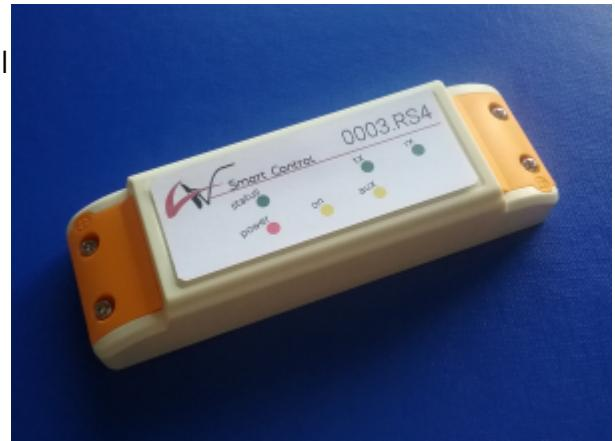
El tamaño del modulo es el de una caja de de 140x45x29mm con el formato típico de fuente de alimentación para iluminación LED, este formato nos proporciona una instalación sencilla y directa en falsos techos, canales, cajas grandes o directamente fijadas a la pared.
