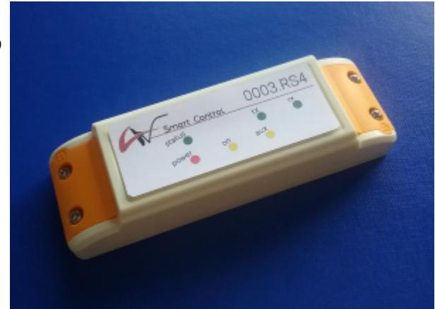
El tamaño del modulo es el de una caja de 140x45x29mm con el formato típico de fuente de alimentación para iluminación LED, este formato nos propicia la instalación de forma sencilla y directa en falsos techos, canales, cajas grandes o directamente fijadas a la pared.
